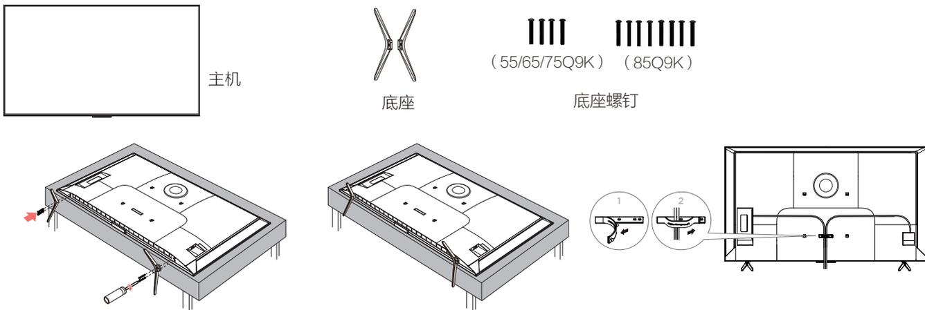
注：不同尺寸底座外观和底座螺丝数量不同，具体以实物为准；固定底座螺钉或相应塑胶件禁止接触油脂及有机溶剂。
